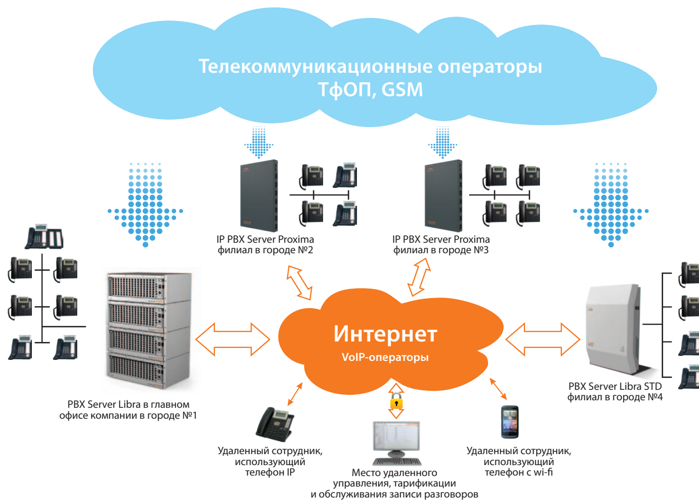
Корпоративная система связи с использованием решений Platan на примере компании с филиалами в нескольких городах
