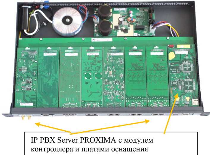
Рис.2 Вид без верхней крышки телекоммуникационного блока IP PBX Server Proxima.
