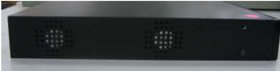
Figure 8. WEC8050 Fan Configuration
