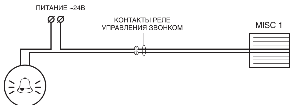
Рис. 7-3 Подключение совместного звонка
