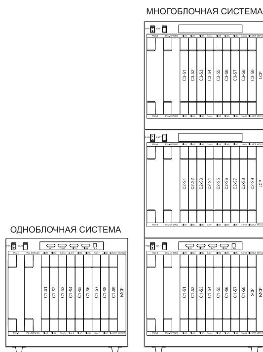
Рис. 10-1 Нумерация блоков и слотов.
