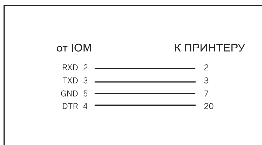
Рис. 7-5 Распайка кабеля для подключения принтера
