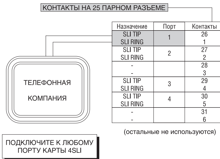
Рис. 5-4 Подключение линий OPX к карте SLI
